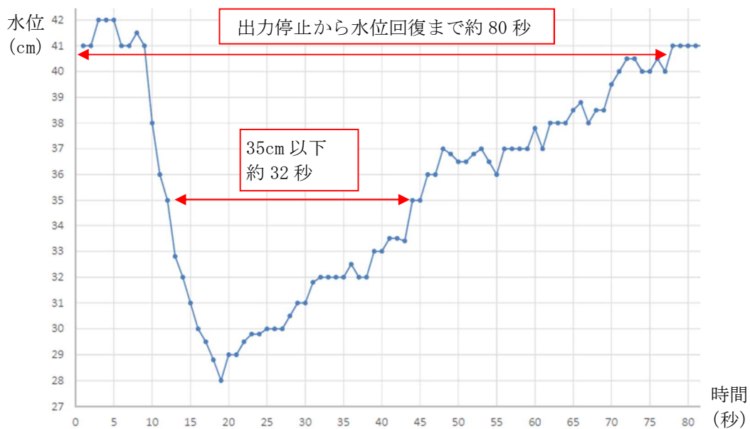
図4 0.2秒以下の短絡の開放でのブレーキ部の水路の水位変化
