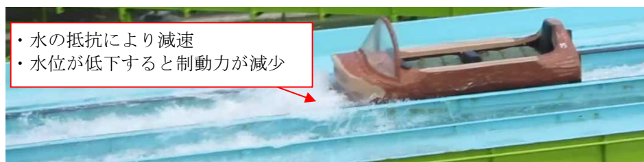
写真3 ブレーキ部での乗物の減速状態
