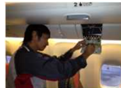
客室内の照明の交換
