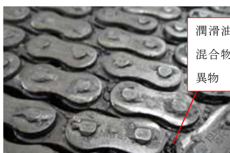
写真 I-3 破断したチェーンの異物の状態
