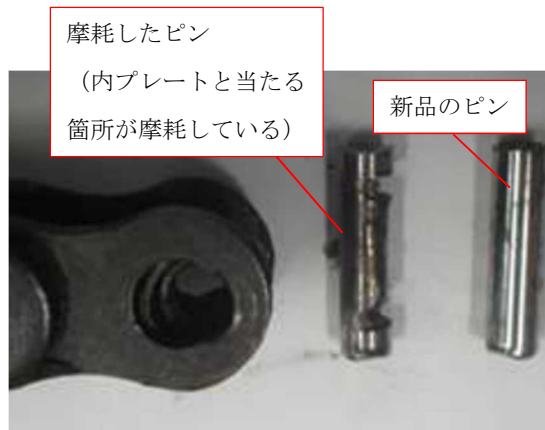
写真 I-5 摩耗したピン
