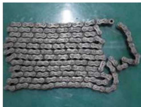
写真 I-1 破断したチェーン
