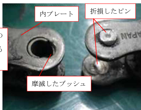
写真 I-4 チェーン破断部
