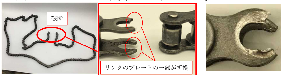
(a) チェーンの破断部
