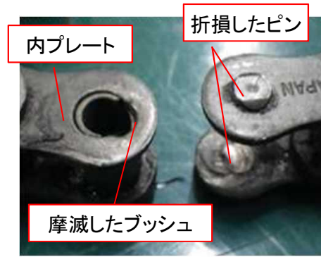
写真1 移動手すり駆動チェーンの破断部
