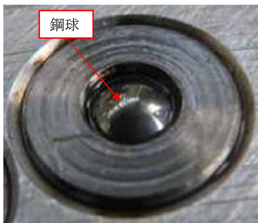
写真4 下降弁安定用チェック弁 (鋼球が弁穴に嵌まり込んだ状態)
