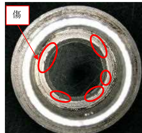
写真5 下降弁安定用チェック弁 出口部の内側の観察
