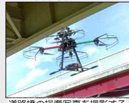
道路橋の損傷写真を撮影するカメラを搭載したドローン
