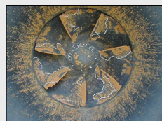
腐食した排水ポンプ場の羽根車
