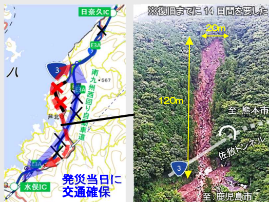
【南九州西回り自動車道と国道3号のダブルネットワーク】 国道3号が大規模土砂災害により2週間以上通行止めとなったが、並行する南九州西回り自動車道により発災当日に八代ー水俣間の広域交通を確保
