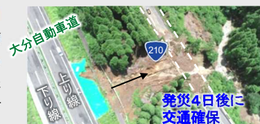
【大分自動車道 九重IC～湯布院IC】 九重IC～湯布院IC間の上り線で路肩崩壊が発生し、並行する国道210号も同時に被災。一時交通が寸断されたものの、大分自動車道の下り線を対面通行として活用することで、発災4日後に広域交通を確保
