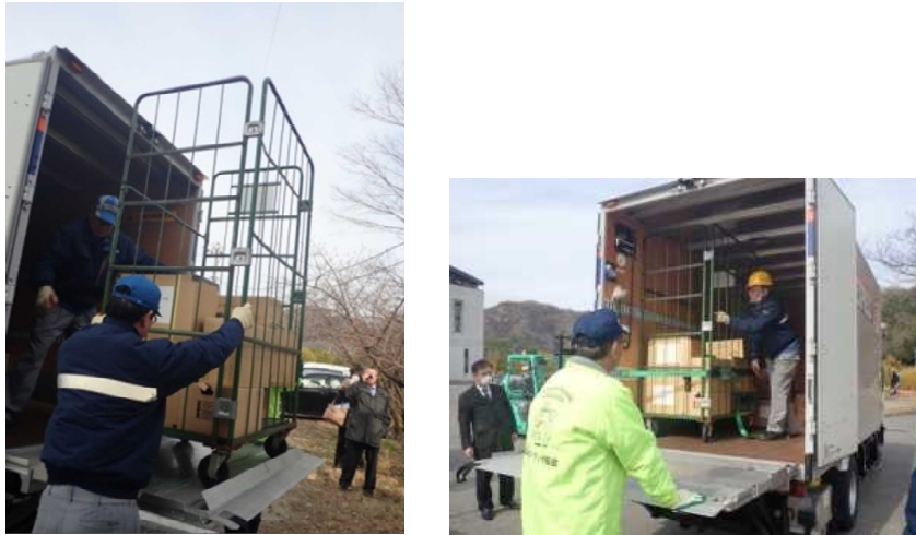
図表Ⅲ－８－３ ロールボックスおよびテールゲートリフターによる物資積込み
