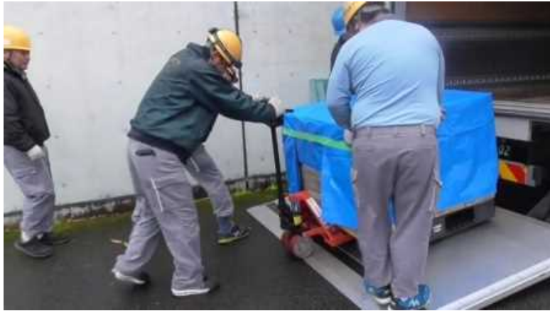
図表Ⅱ－３－７ パレット積載状態でのハンドリフト+テールゲートリフター荷積み
