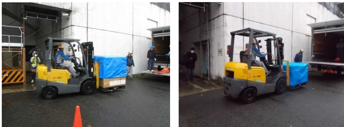
図表Ⅱ-3-5 パレット積載状態でのフォークリフト荷積み
