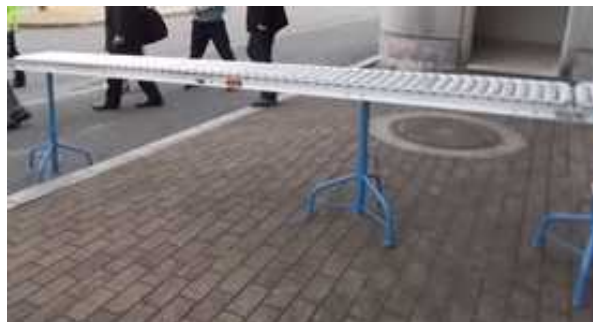
図表Ⅲ－５－９ ローラーコンベヤ（スタンドを付けた状態）
