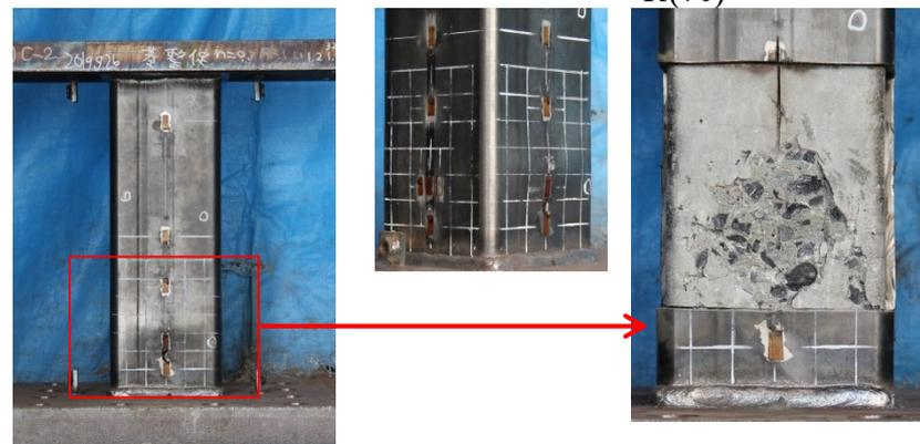
振幅が大きいほうが、同じサイクル数における耐力低下が大きく、局部座屈変形も大きい。
