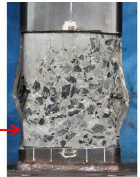
軸力比が大きいと耐力低下が著しい。局部座屈変形も大きい。
