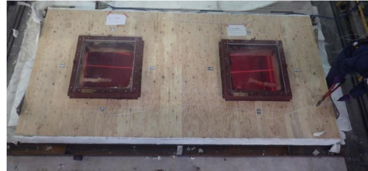
試験後(天窓部分に大きな損傷はない)
