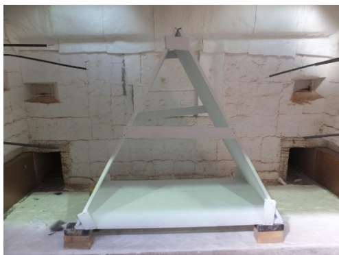
水平炉の高温ガス拡散板の配置
