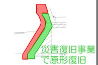
被災した護岸を災害復旧事業による原形復旧にあわせて、推進費により嵩上げを実施。
