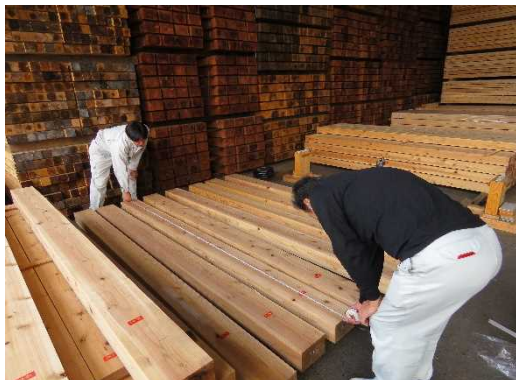
<抜き取り検査>
