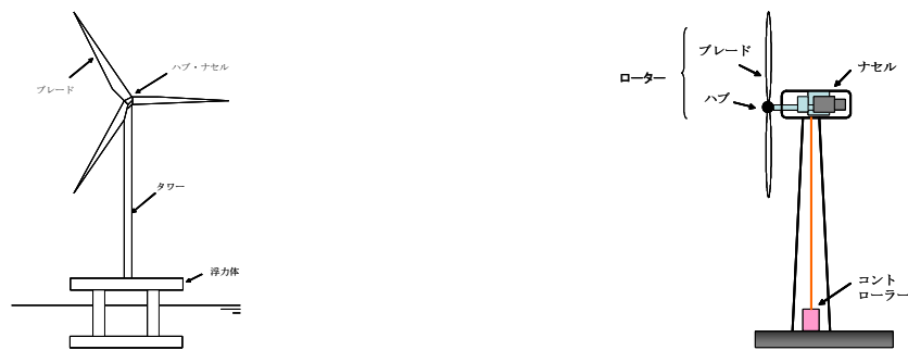
図 2-1 浮体式洋上風力発電施設の例
