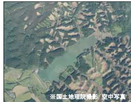
【早来地区】瑞穂ダム 貯水池内への土砂、倒木流入
