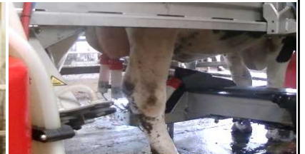
レーザーによるセンシング技術で乳頭の位置や形を検知し、搾乳カップを装着。
