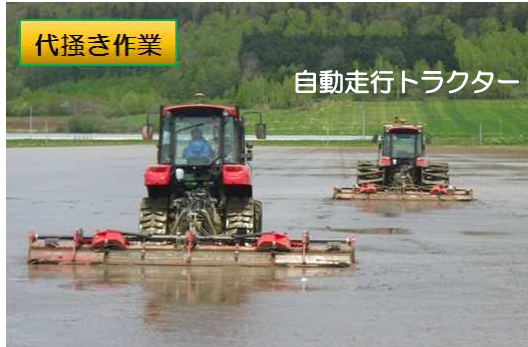
自動走行トラクター(有人のトラクターと協調して作業)
