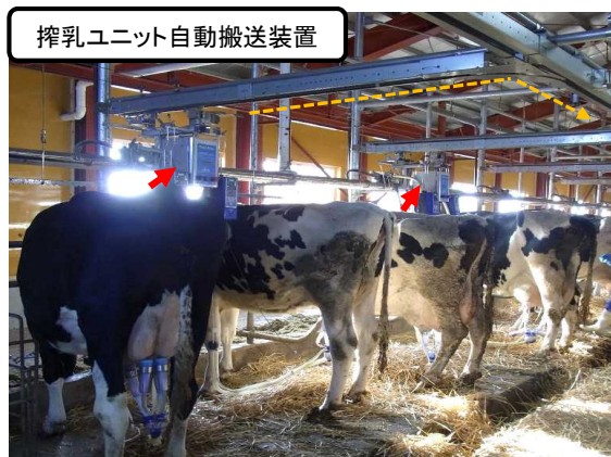
牛が自発的に搾乳ロボットに入ることによって搾乳が行われる。
