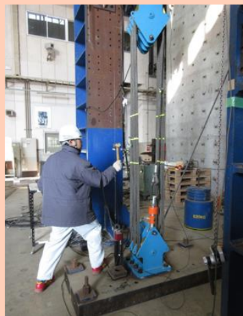
打診検査による振動数測定
