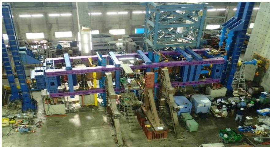
高軸力(圧縮2000t引張800t)下での曲げせん断載荷装置
