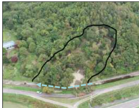
【新鷗川地区】川西幹線用水路 流入した土砂による開水路の閉塞
