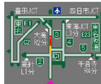
道路情報板の視認性向上 (大型マルチカラー化の例)
