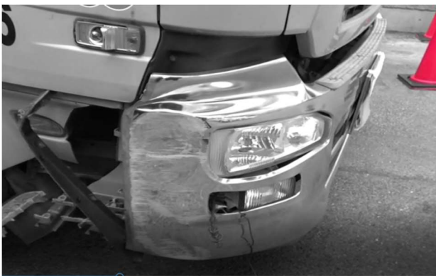
写真2 バンパー右側面の損傷
