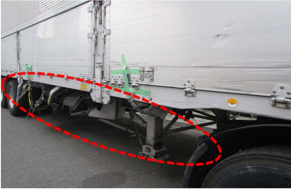
写真4 トレーラ部右側下部の損傷
