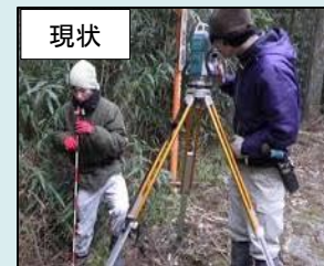
現状 土地の境界点について、現地に測量機器を設置し、1点毎に座標値の測量を実施
