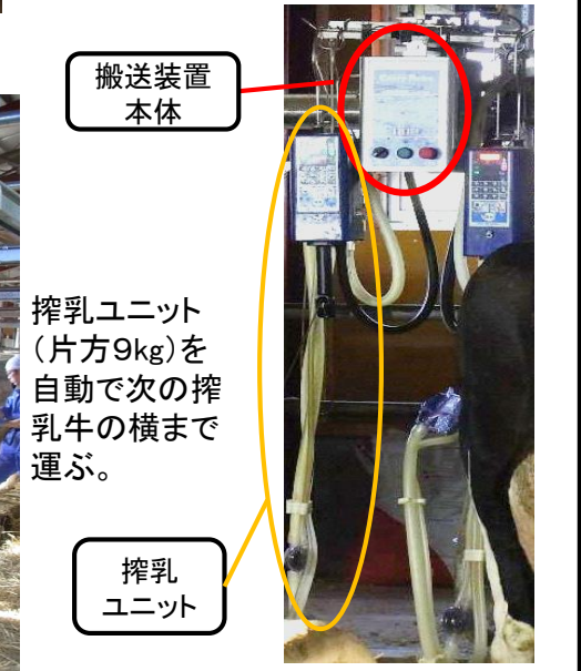
牛が自発的に搾乳ロボットに入ることによって搾乳が行われる。
