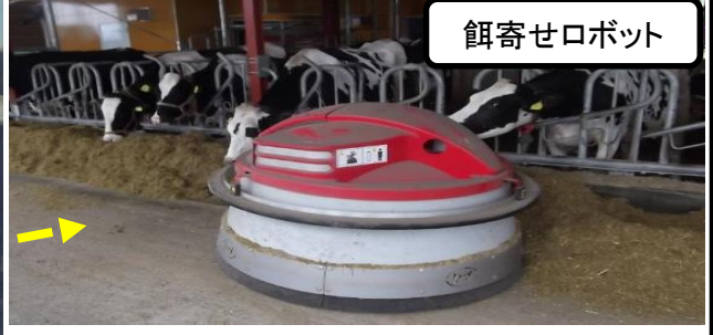
回転しながら走行し、牛の口元に餌を戻すことで食べ残しを低減。
