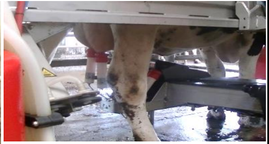
レーザーによるセンシング技術で乳頭の位置や形を検知し、搾乳カップを装着。
