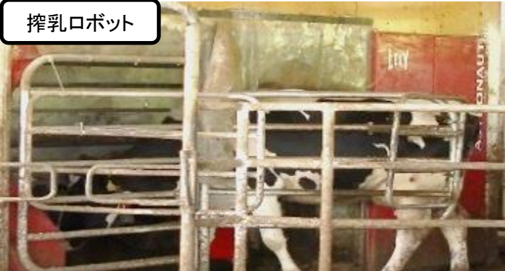
牛が自発的に搾乳ロボットに入ることによって搾乳が行われる。
