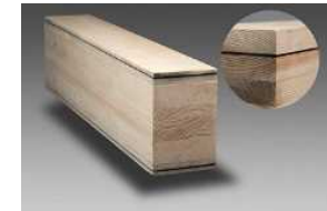
炭素繊維を用いた木造建築用集材材
