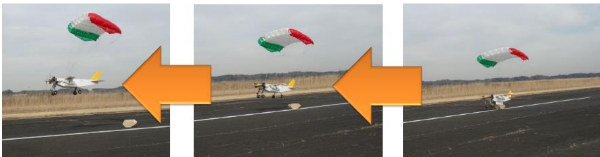
図 2-13 物資運搬コンテナの自動切り離し
