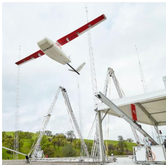
図 2-25 固定翼ドローン Zips と発射設備のイメージ
