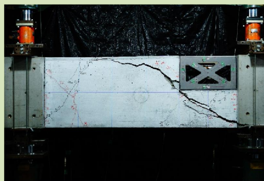
(a) 主筋2-D16(人通口中央) (b) 主筋2-D16(人通口端部) (c) 補強金物の座屈 人通口を有する布基礎梁試験体の最終破壊状況の一例
