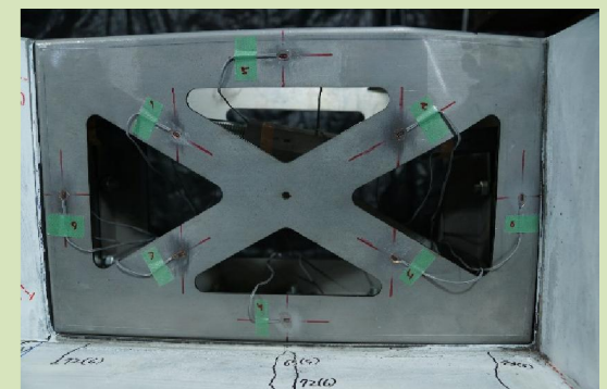
(a) 主筋2-D16(人通口中央) (b) 主筋2-D16(人通口端部) (c) 補強金物の座屈 人通口を有する布基礎梁試験体の最終破壊状況の一例
