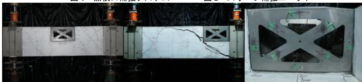
(a) 主筋 2-D16(人通口中央) (b) 主筋 2-D16(人通口端部) (c) 補強金物の座屈
