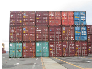
写真 3.2.4 ラッシングベルトによる固定
