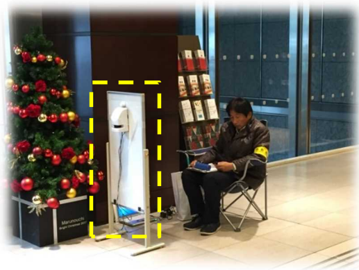
図 5-5 ビル出入り口でのレーザーカウンターと人手による観測の実施
