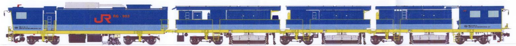
レール削正車の側面図 [1編成の半分]
