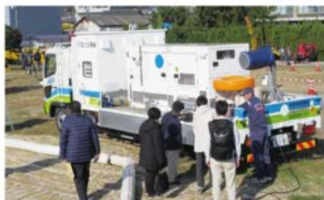
洪水等の被害が予想される時に出動する排水ポンプ車の見学
