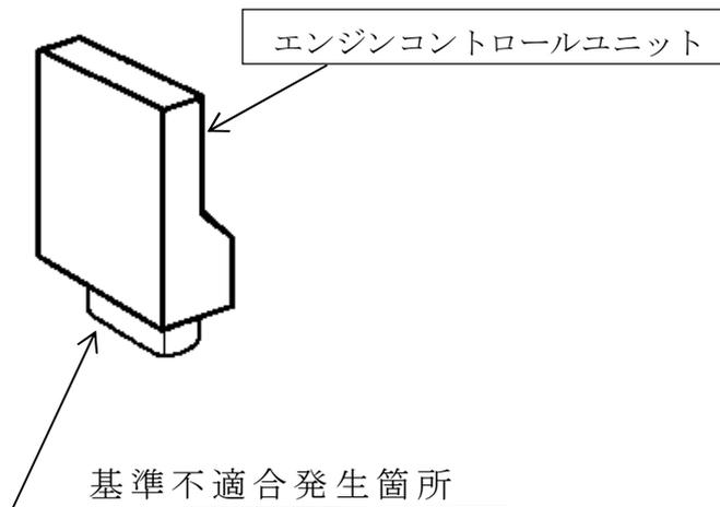
車載式故障診断装置において、エンジンコントロールユニット（ECU）のプログラムが不適切なため、外部診断器（スキャンツール）接続後にECUが保安基準第31条の基準に適合しない通信処理を行う。そのため、スキャンツールによってはECUとの通信が不能となり、故障診断ができないおそれがある。
