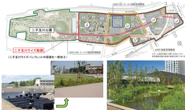
公園広場の地下に埋設されている雨水貯留施設 (世田谷区ホームページより引用) 再開発により約6千㎡の屋上緑化など約1万㎡を緑化 (二子玉川ライズパンフレットより引用)
