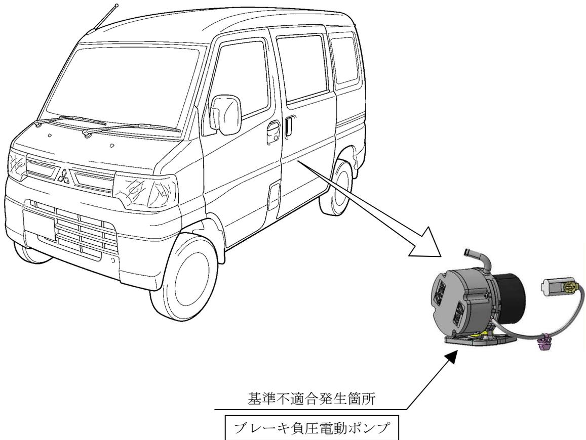
ブレーキ倍力装置に負圧を発生させるブレーキ負圧電動ポンプにおいて、主軸のベアリングに異品が装着されているため、早期にベアリングが焼き付くおそれがある。そのため、ブレーキ負圧電動ポンプが停止し、ブレーキ警告灯が点灯するとともに警告音が鳴り、そのままの状態で使用するとブレーキペダルの操作力が増大し、制動距離が長くなるおそれがある。
