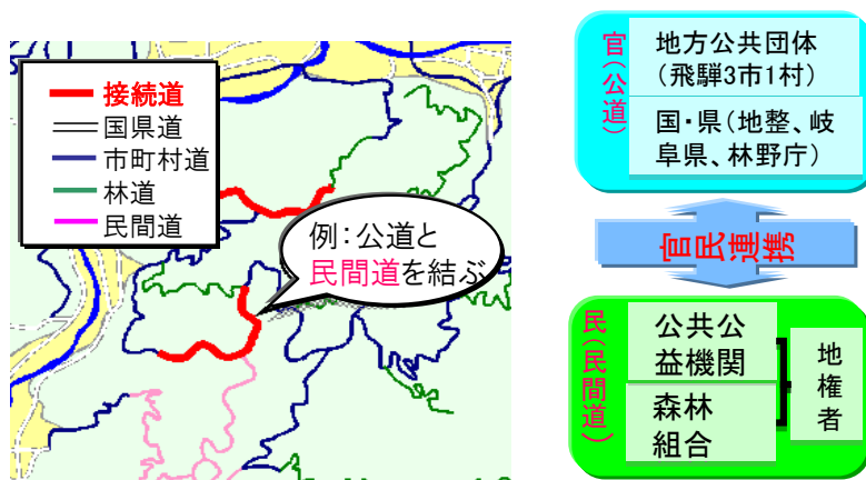
図 4-1 官民連携による異種の道ネットワーク形成のイメージ
