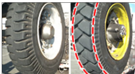
左:新品タイヤ/右:再生タイヤ (点線部分が貼り付け部分)
