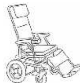
リクライニング型 リクライニング時の全長が長い。 姿勢を変える必要のある人が使う。
