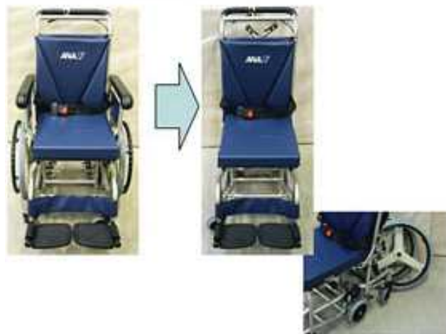
機内乗込用車椅子 主輪を取り外すと幅 400mm程度になる。
