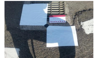
標定点(境界標識や基準点等)の例 ※写真により判読が難しい場合には目印を設置
