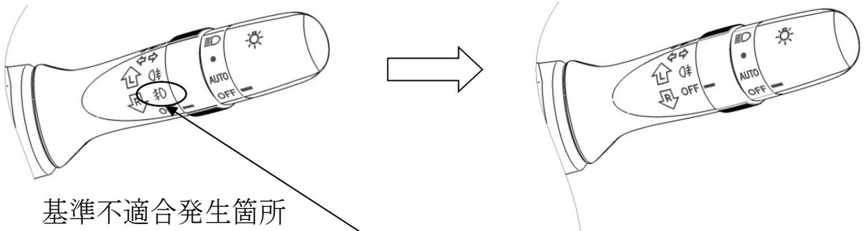
後付け用品であるバンパーサイドベゼルにおいて、設計時の保安基準適否の検証が不十分なため、スバルWRX S4「DBA-VAG」に装着された場合、フロントフォグランプが取り外されている状態にもかかわらず、フロントフォグランプスイッチ操作によりメーター内のインジケータが点灯する。そのため、協定期則第121号に適合せず保安基準不適合となる。
