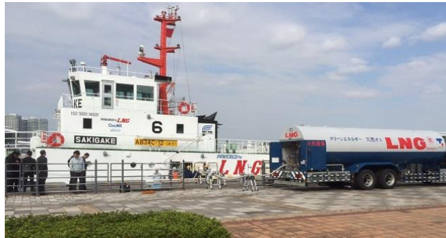
タンクローリーから燃料船へのバンカリング
