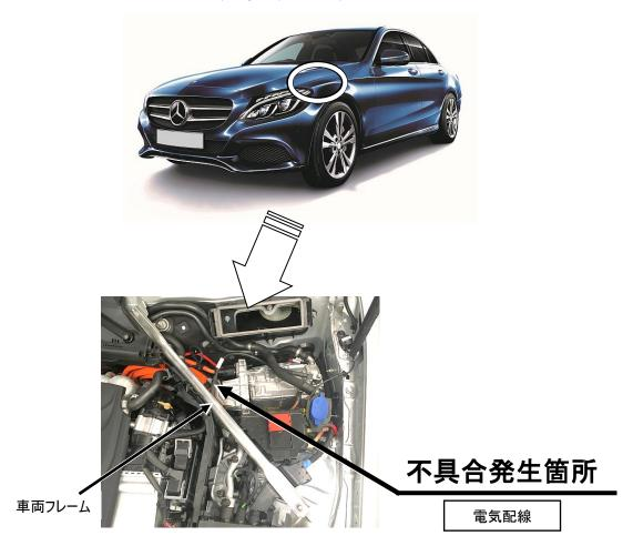
注: は、点検し干渉がある場合は、適切な配策へ修正、被覆が削れている場合は、交換を行う 部品を示す。
