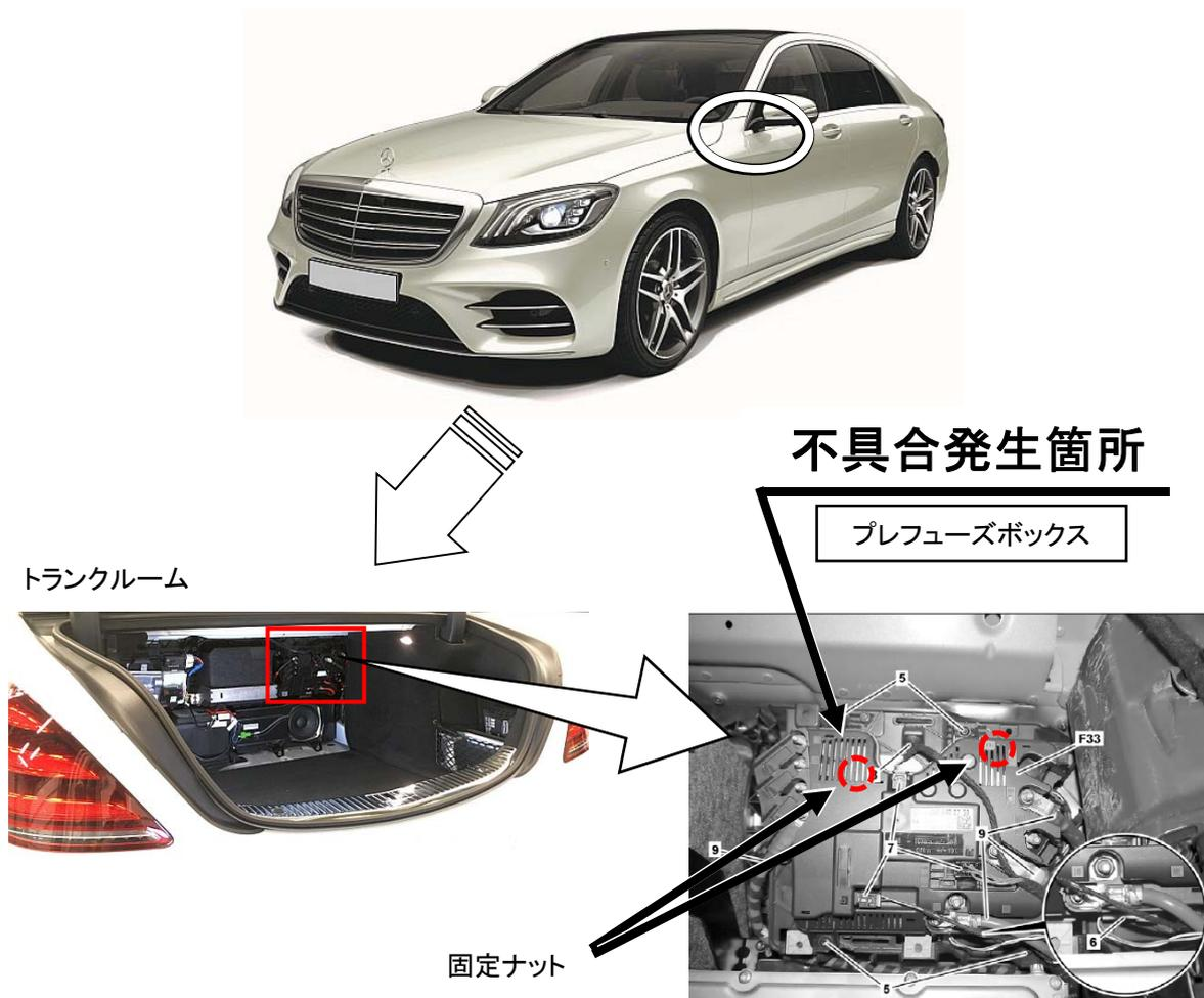
注：  は、点検し、固定ナットが取り付けられていない場合には交換する部品を示す
