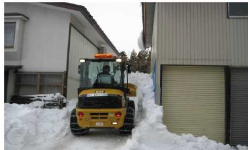
ミニホイールローダによる除雪作業の様子
