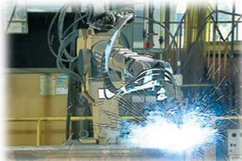
台車枠製造(台車枠溶接) (一例)
