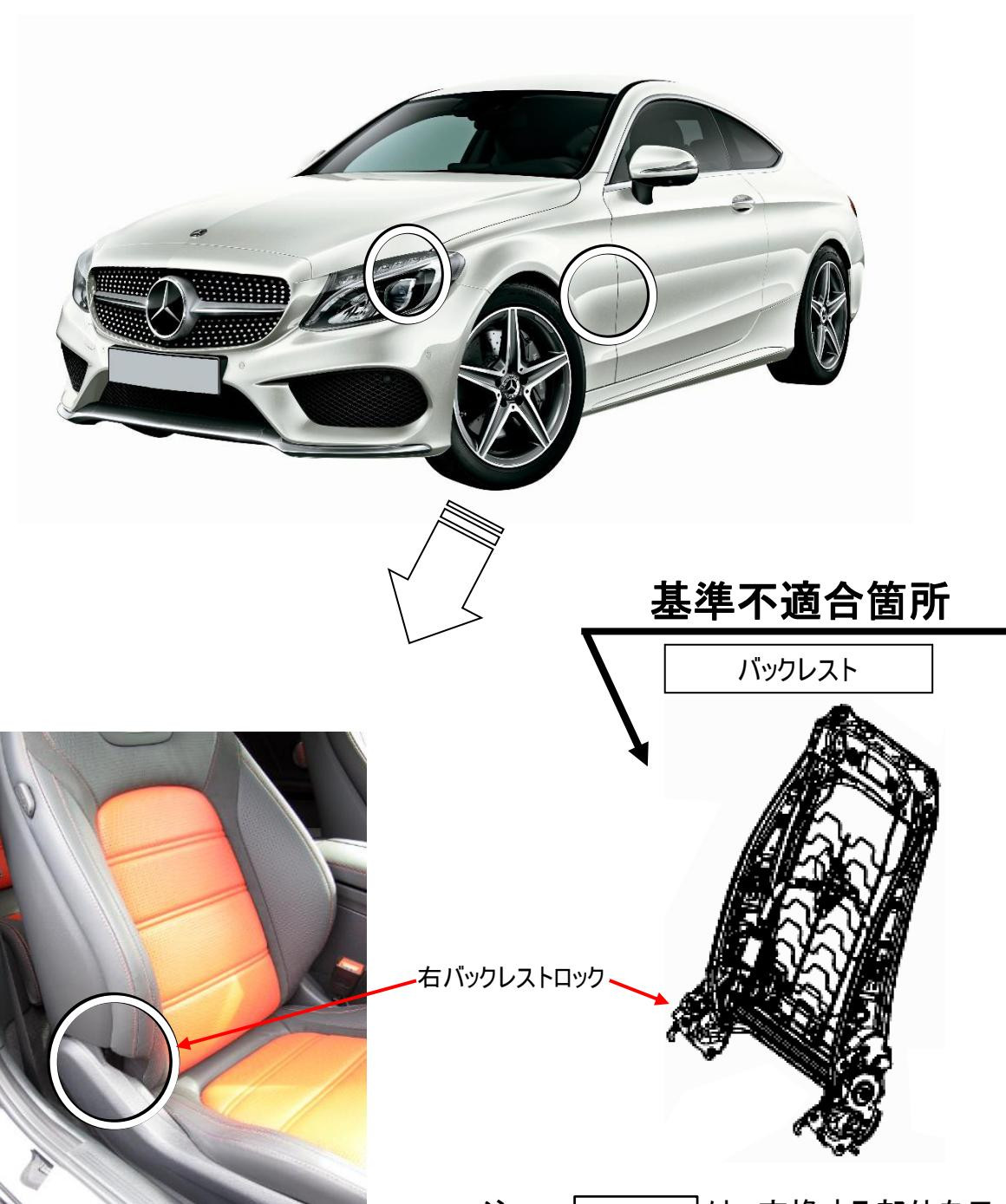
運転席及び助手席のバックレストのロック機構において、構成部品の寸法が不適切なため、ロック機構が正常に作動せず、バックレストが確実に固定されないことがある。そのため、衝突等によりバックレストに強い力が加わった際、バックレストが前方に倒れ、最悪の場合、乗員が負傷するおそれがある。
