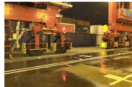
RTG同士の衝突防止試験
