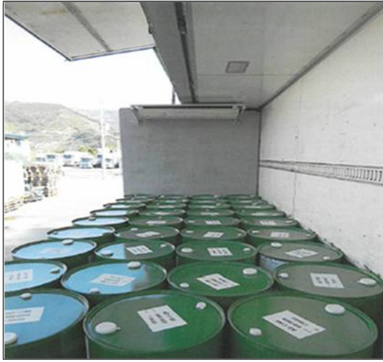
写真4 ドラム缶積載状況 (当該事業者の同型車両での再現例)
