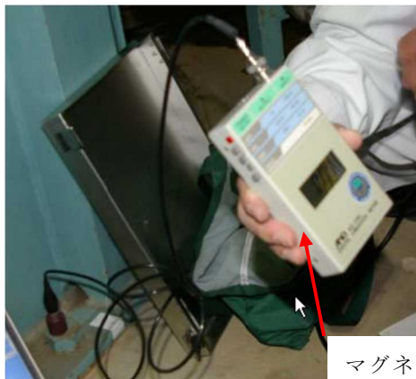
写真 4.1 振動測定状況（マグネット式振動センサ）
