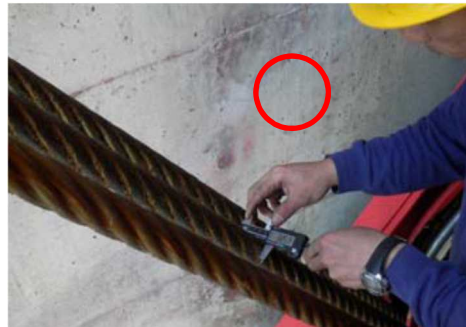
参考図 2.1 ワイヤロープ外径測定方
