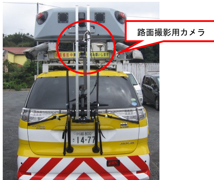
図 3-25 路面撮影用カメラ搭載状況
